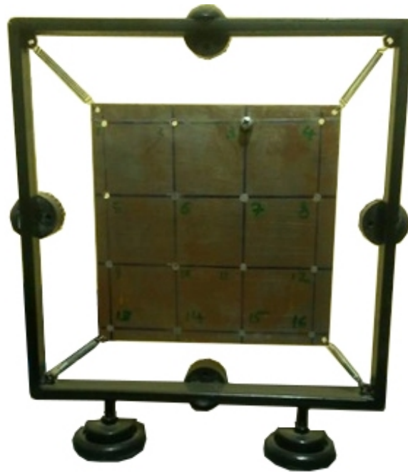
شکل (34). صفحه فولادی تست مودال
